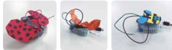
e. Conectar los cables del vibrador a los cables de la pila. Si la pila no tiene cables, bastará con hacer contacto sobre ella con los cables del vibrador. De esta manera se pone en funcionamiento el bicho robot.
